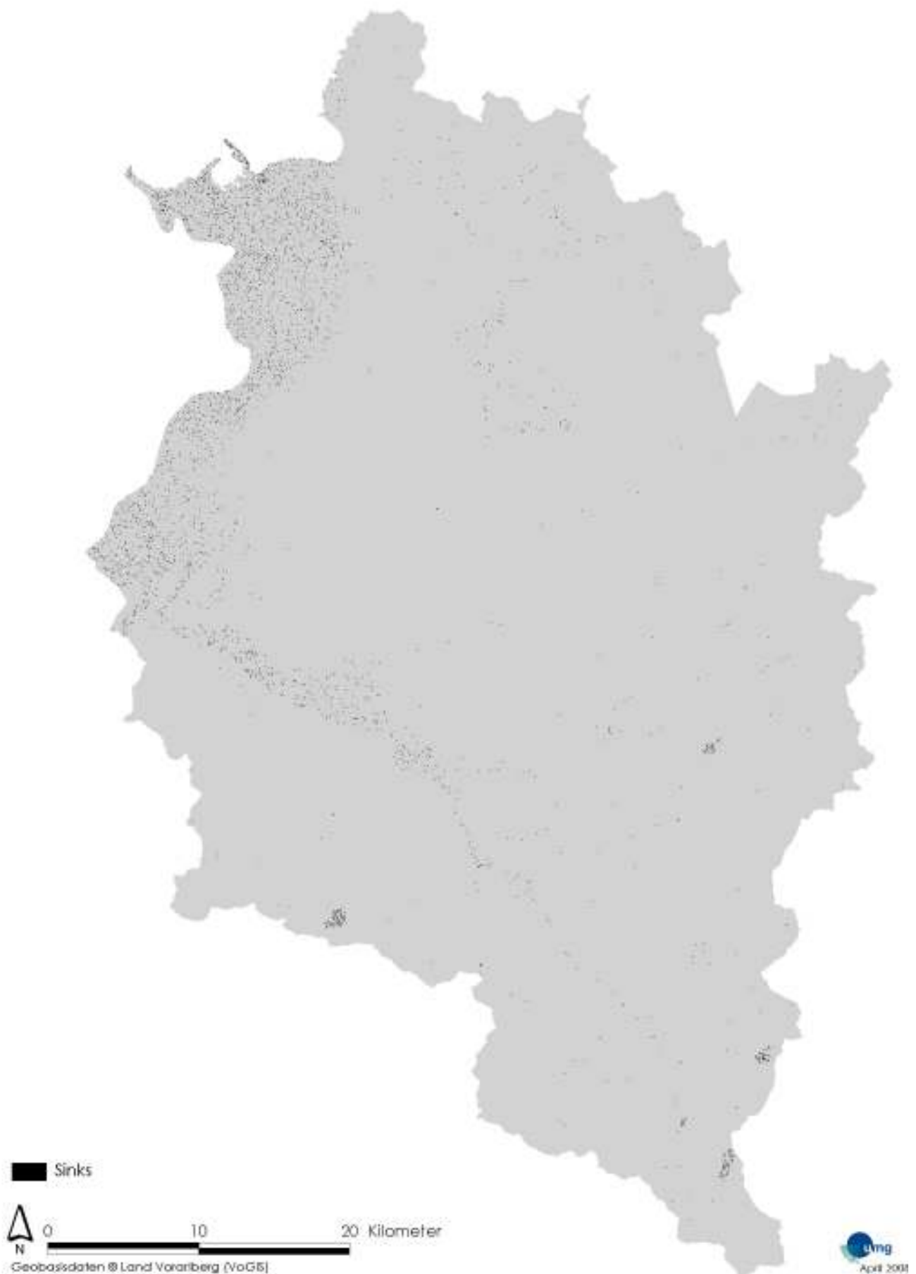
Abb 5: Sinks sind Rasterzellen, deren Abflussrichtung nicht eindeutig bestimmt werden kann. Sie müssen für die weitere Berechnung korrigiert werden. Für die bessere Darstellung wurden die Sinks leicht vergrößert.
